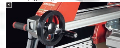
9 Optional: art. 1305F1 (standard x mod. 181cm) Kit avanzamento con volantino - sistema che fornisce prestazioni di taglio senza sforzo e facile Hand Wheel Feed Kit – a System that provides effortless & easy cutting performance
